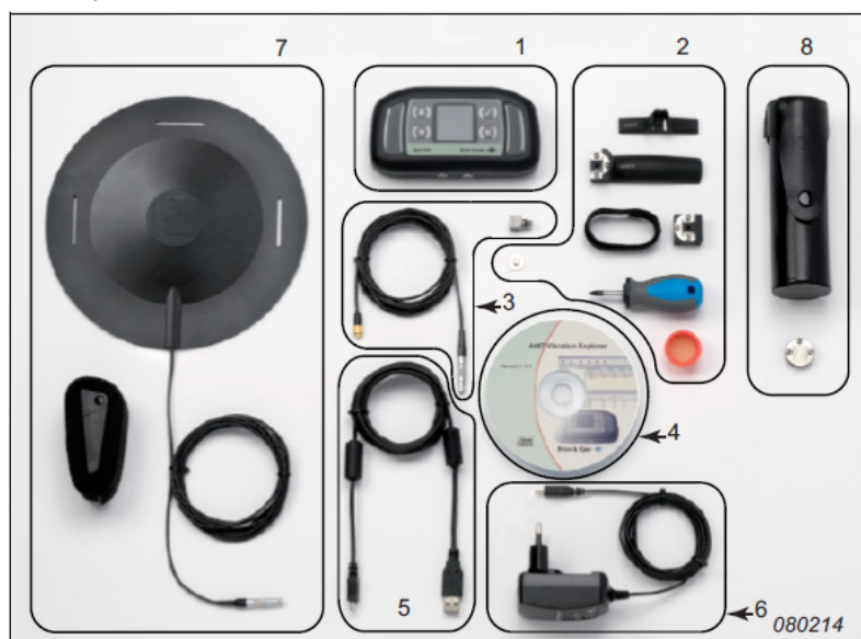
Sl. 6.7 Merni lanac za merenje vibracija šaka-ruka [4]
