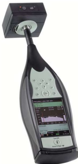
Sl. 1.18 Postavljanje kalibratora na mikrofoni
